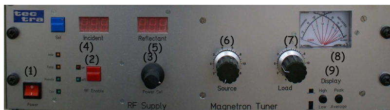
Figura 1.9. Panoul de comandă al generatorului RF
